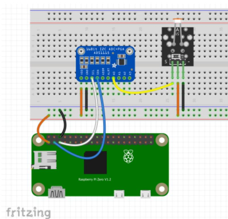
Auf der Platine in der Wetterstation wird der Sensor auf die gleiche Platine wie der Helligkeitssensor gesetzt. Der Anschluss ist dazu bereits komplett vorbereitet. Es ist ansonsten nichts weiter notwendig. Siehe Kapitel [9. Helligkeit](#)
