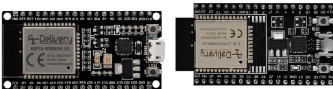
Links: [ESP-32 Dev Kit C V2](#) - Rechts: [ESP-32 Dev Kit C V4](#) / Beide Abbildungen © <https://www.az-delivery.de/>
