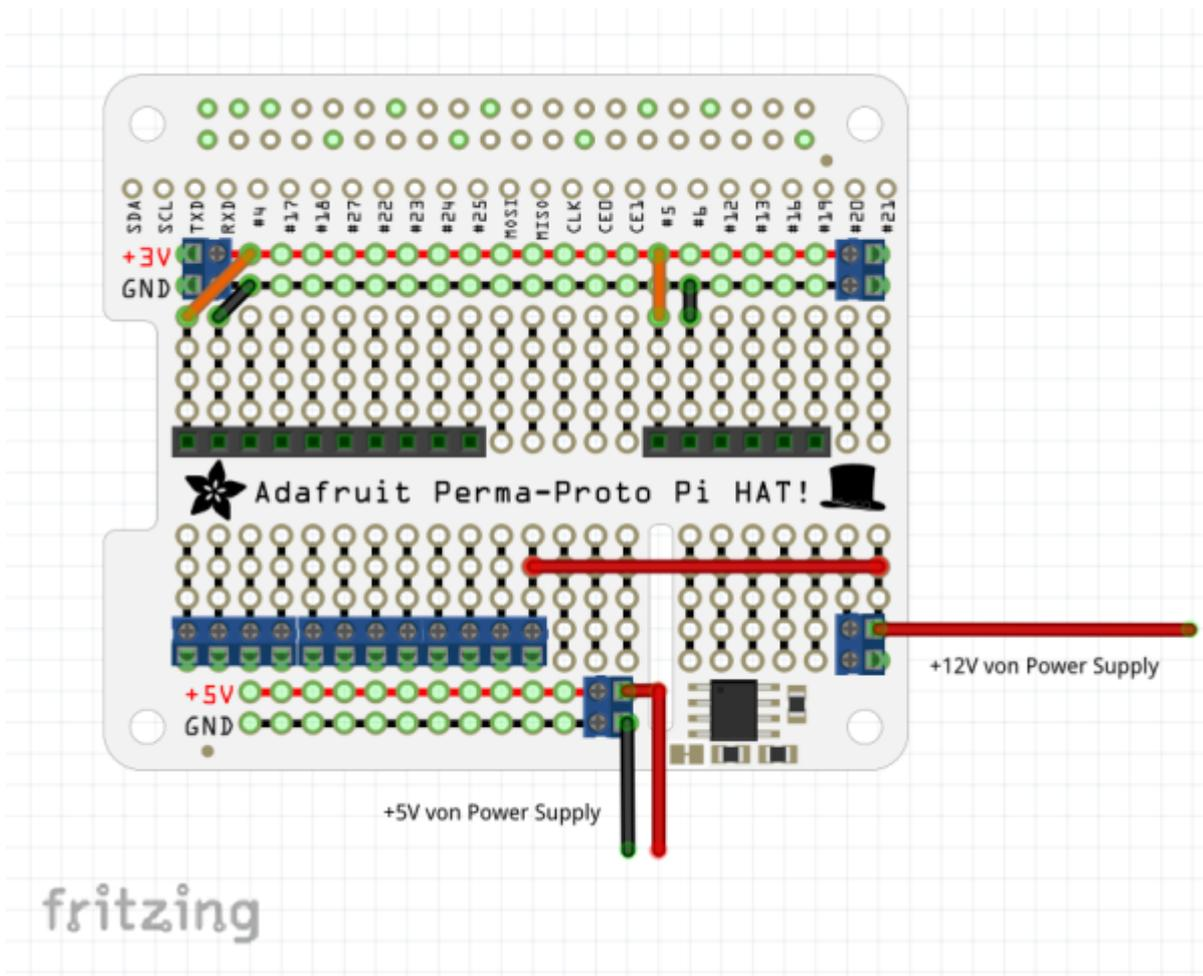
Als letzten Schritt im Grundaufbau verbinden wir den I2C Bus (SDA und SCL) mit den jeweiligen Buchsen. Dieser Bus wird von sehr vielen Sensoren benötigt, daher braucht ihr ihn auf jeden Fall. Mit diesem Schritt ist das Grundgerüst schon einmal fertiggestellt! Im folgenden geht es dann spezifisch für die Sensoren weiter, die ihr in eurer Wetterstation auch verbauen wollt.
