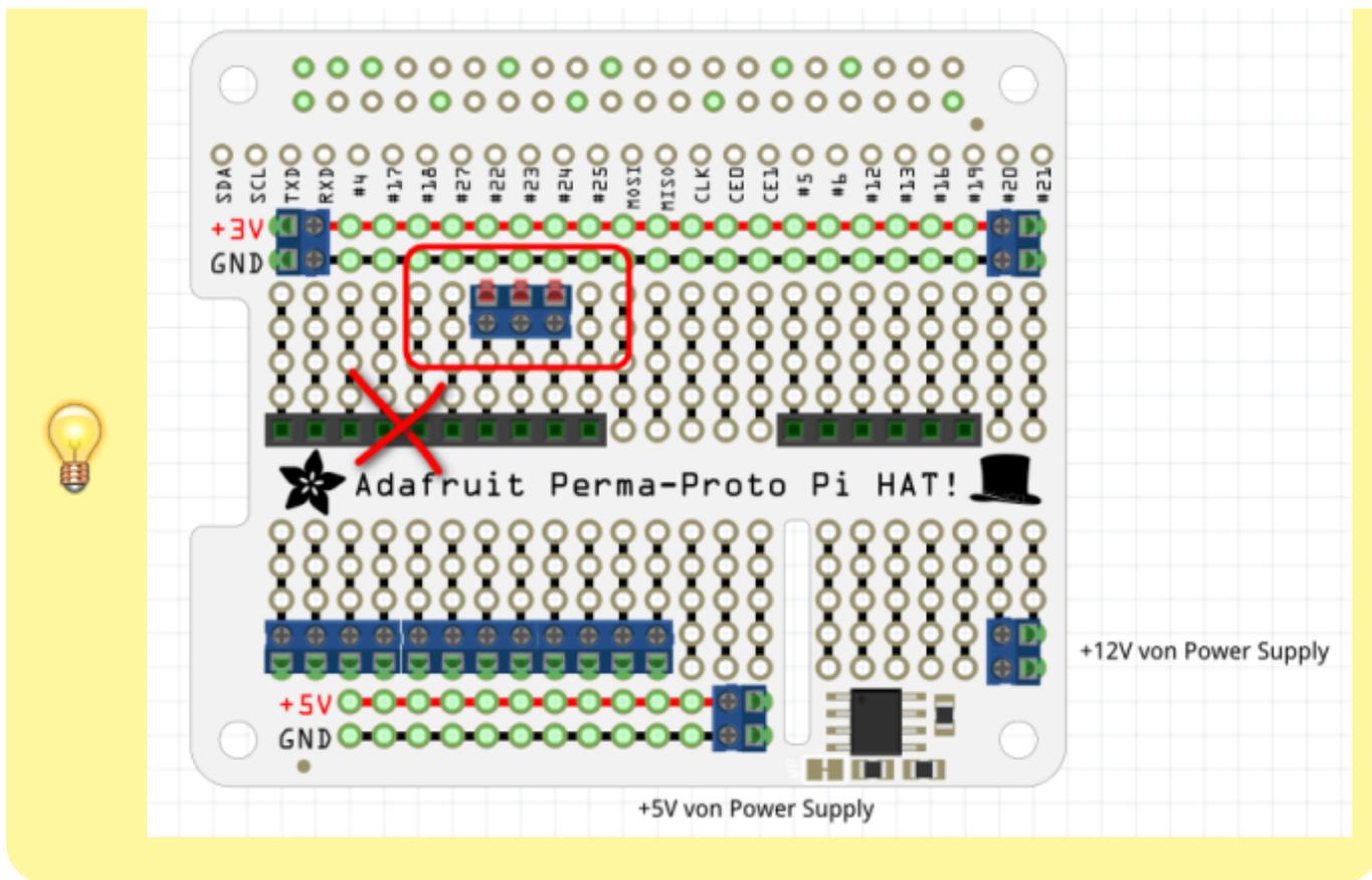
Auf die Buchsenleisten können später die beiden Sensormodule ADS1115 (für Dämmerungssensor, Windgeschwindigkeit und -richtung sowie UV-Sensor) und der INA219 (für den Solarstrahlungssensor) gesetzt werden. Von der Spannungsversorgung werden +5V sowie +12V an die gekennzeichneten Buchsen geführt.
