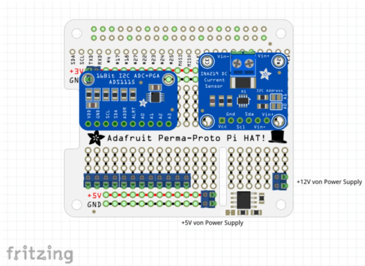
Im nächsten Schritt verbinden wir die Spannungsversorgung von 3.3V und 12V zu den einzelnen Punkten, wo sie benötigt werden.
