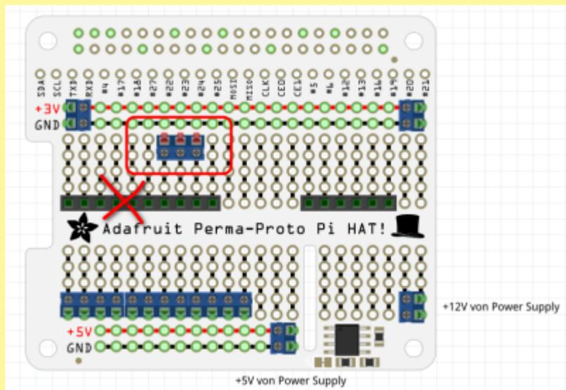
Auf die Buchsenleisten können später die beiden Sensormodule ADS1115 (für Dämmerungssensor, Windgeschwindigkeit und -richtung sowie UV-Sensor - nur für den Raspberry, nicht für den ESP32) und der INA219 (für den Solarstrahlungssensor) gesetzt werden. Von der Spannungsversorgung werden +5V sowie +12V an die gekennzeichneten Buchsen geführt.
