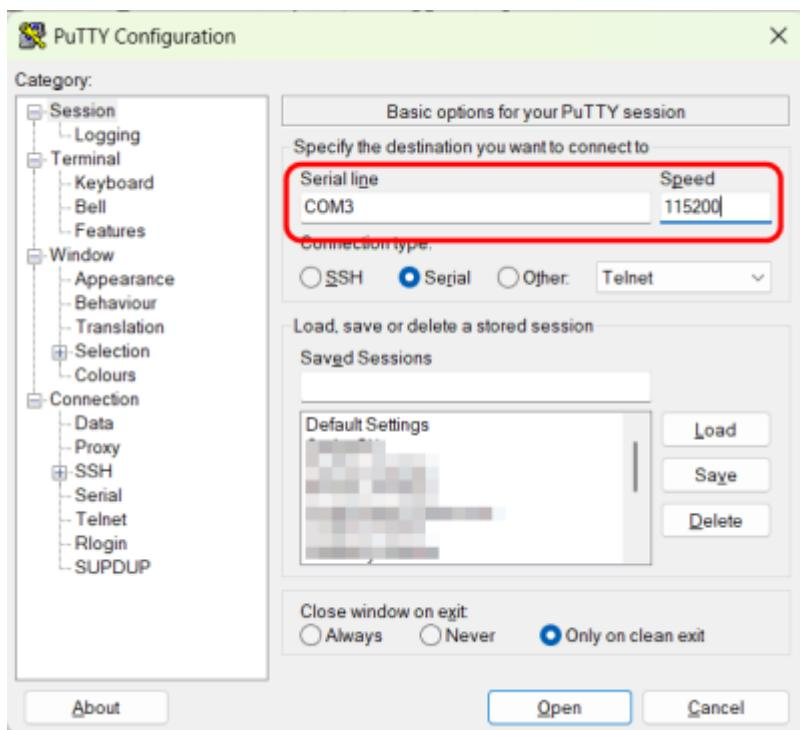
Nun verbindet ihr den ESP32 wieder mit dem Rechner, wartet 1-2 Sekunden, bis der ESP erkannt wurde und klickt in PuTTY dann auf Open. Ihr solltet nun in PuTTY die Bootmeldungen des ESP32 sehen und er sollte das WLAN zur Erstkonfiguration aufmachen - die Meldungen sollten in etwa so aussehen und Euch die SSID des AP sowie die temporäre IP-Adresse des ESP32 mitteilen:
