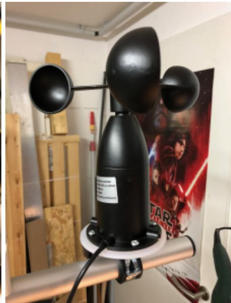
Mit etwas "sanfter Gewalt" bekommt man den großen Zwischenstecker noch mit in das Gehäuse des Windsensors gequetscht. Das Kabel des Windsensors (Kabel 8) wird dann [durch das Halterungssystem](#) zum [Solarstrahlungssensor](#) geführt, wo es im Gehäuse mit angeschlossen wird.
