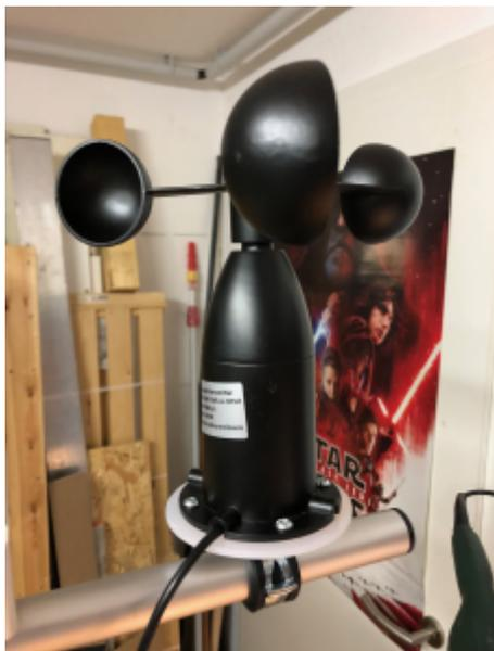
Mit etwas "sanfter Gewalt" bekommt man den großen Zwischenstecker noch mit in das Gehäuse des Windsensors gequetscht. Das Kabel des Windsensors (Kabel 8) wird dann [durch das Halterungssystem](#) zum [Solarstrahlungssensor](#) geführt, wo es im Gehäuse mit angeschlossen wird.
