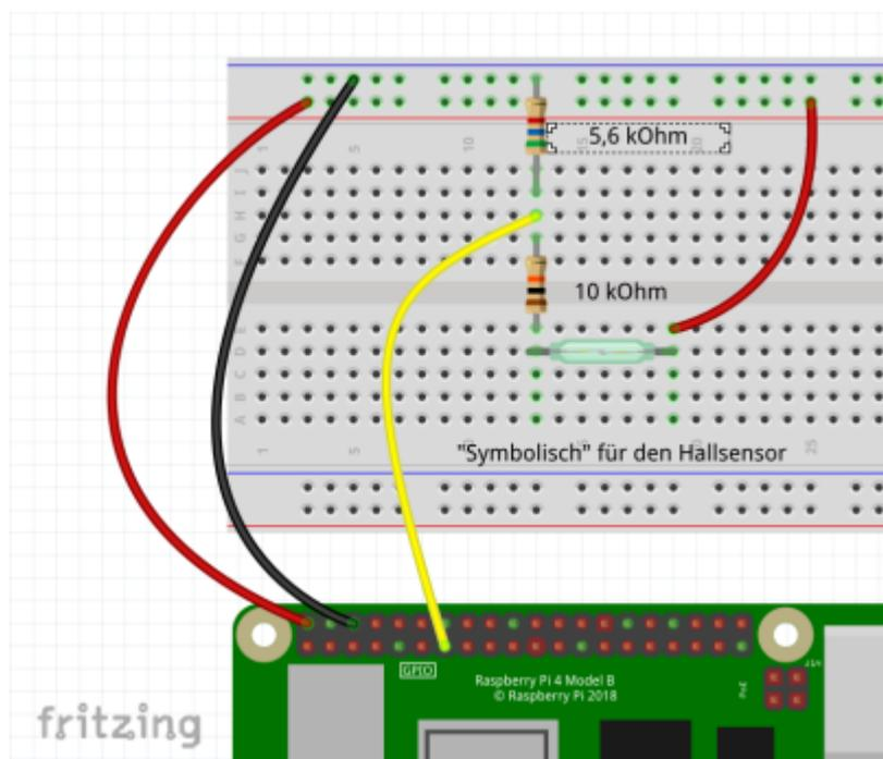
Angeschlossen wird er dann im Gehäuse des [Solarstrahlungssensors](#) auf der Platine:
