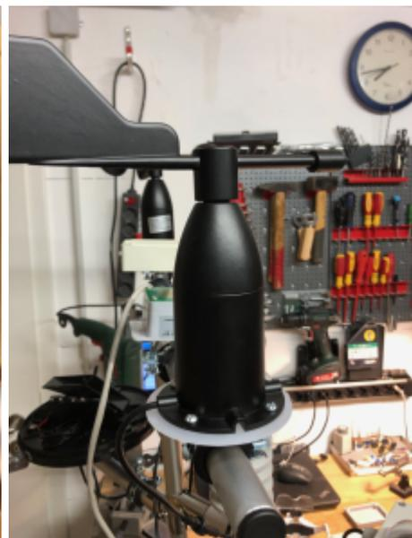
Mit etwas "sanfter Gewalt" bekommt man den großen Zwischenstecker noch mit in das Gehäuse des Windsensors gequetscht. Das Kabel des Windsensors (Kabel 7) wird dann [durch das Halterungssystem](#) zum [Solarstrahlungssensor](#) geführt, wo es im Gehäuse mit angeschlossen wird.
