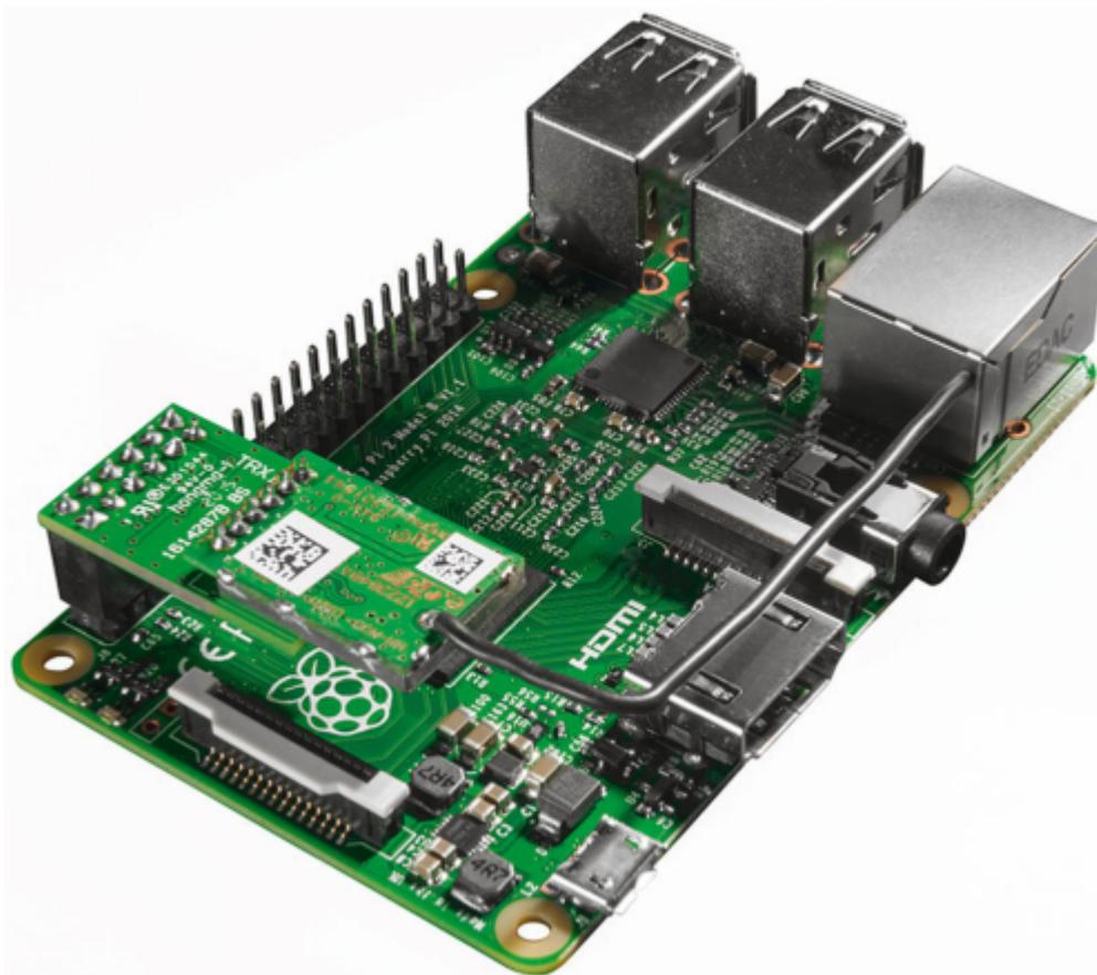
Aufgestecktes HM-MOD-RPI-PCB auf einem Raspberry Pi, Quelle: [ELV Webshop](#)
