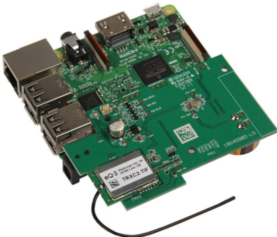
Aufgestecktes RPI-RF-MOD auf einem Raspberry Pi, Quelle: [ELV Internetshop](#)
