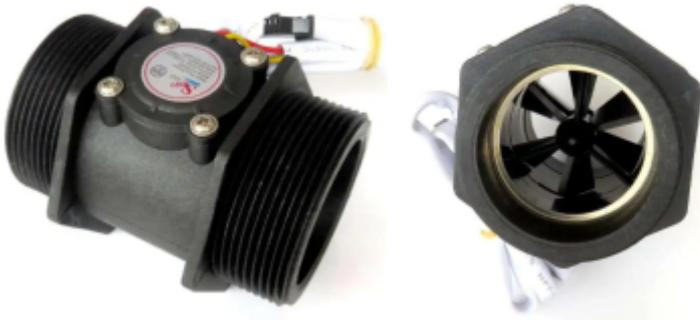
Das Messprinzip der Sensoren basiert auf dem Hall-Effekt: An einem Flügelrad, welches proportional zur Durchflussmenge rotiert, sind zwei Magneten angebracht, sie erzeugen ein magnetisches Feld, welches von einem Hallsensor in ein elektrisches Signal umgewandelt wird. Dieses wird in Form einer Frequenz ausgegeben.
