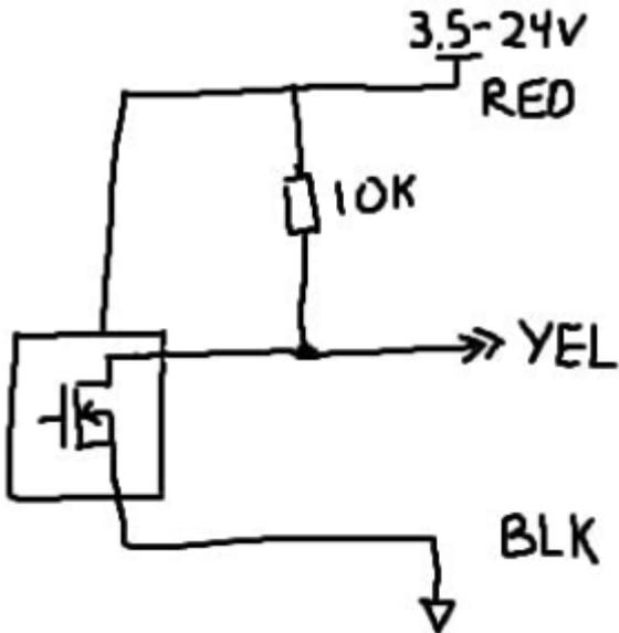
Man sieht, dass die Eingangsspannung VCC+ (Rot) über den Hallsensor an DATA (Gelb) durchgereicht wird. Über einen eingebauten PullUp-Widerstand wird DATA (Gelb) auf die Eingangsspannung gezogen. Bei einem Impuls wird DATA (Gelb) auf Ground gezogen (also eine fallende Flanke).
