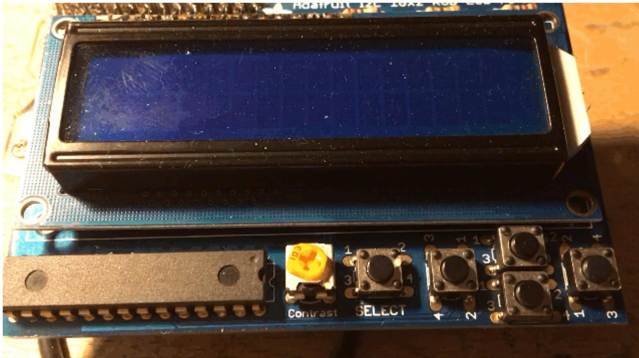
Zur Bedienung oder zum Ablesen von Messwerten im Poolhaus kann ein LCD Display an den LoxBerry angeschlossen werden. Es wird ausschließlich das [Adafruit LCD+Keypad Kit for Raspberry Pi](#) unterstützt. Andere LCD Displays funktionieren mit dem Plugin nicht.
