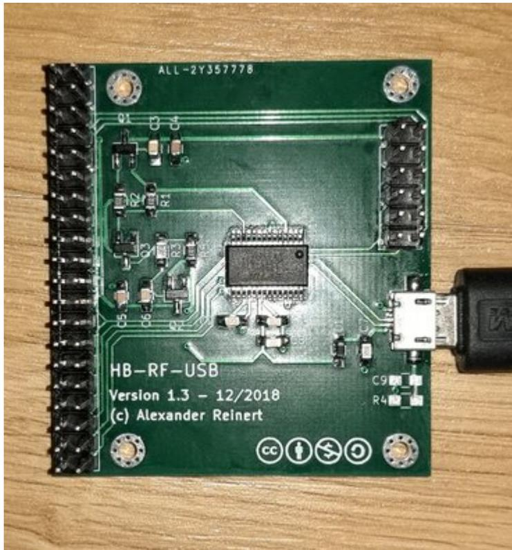
Diese USB-Platine ist eine Eigen-Entwicklung von Alexander Reinert! Sie bietet eine USB-Schnittstelle zu den Original-GPIO-Aufsteckmodulen von eQ3. Es ist also zusätzlich zur Platine auch noch die Aufsteckplatine RPI-RF-MOD bzw. RPI-RF-MOD notwendig (siehe oben). Der große Vorteil liegt darin, dass damit das LoxMatic Plugin auch auf anderen Hardware-Plattformen (z. B. in einer Virtuellen
