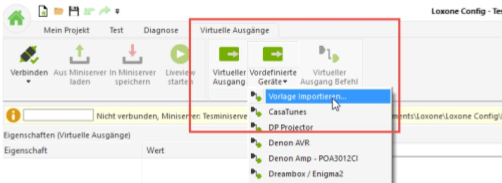
Bis LoxConfig Version 8 muss die Datei manuell in das Verzeichnis C:\ProgramData\Loxone\Loxone Config VERSION\Templates\VirtualOut kopiert werden. Sie muss dabei unbedingt mit **VO\_** beginnen, damit sie erkannt wird. LoxConfig muss anschließend neu gestartet werden.
