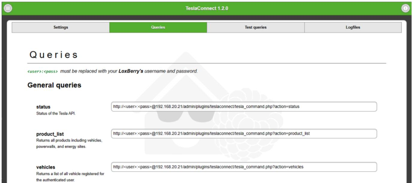
Diese müssen in der Loxone Config als Virtuelle Ausgänge definiert werden. Wenn diese Ausgänge getriggert werden, führt das Plugin die gewünschte Funktion aus. Der Aufruf der virtuellen Ausgänge kann über die Standard Bausteine von Loxone erfolgen.
